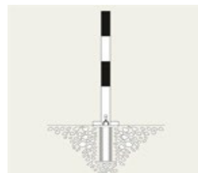
zum Einbetonieren: Pfostenlänge: 1330 mm davon 330 mm Unterflur
