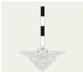
zum Aufdübeln: Pfostenlänge: 1000 mm (Lieferung ohne Befestigungsmaterial)
